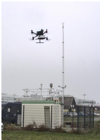
Knestel Photoakustischer Sensor (PAS) montiert an einer Drohne. Dahinter ist eine Umweltmessstation zu sehen
