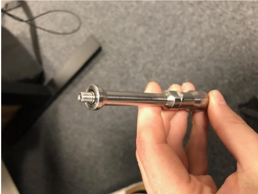
Abbildung 26: Düse (oberer und unterer Teil) des Salzgenerators
